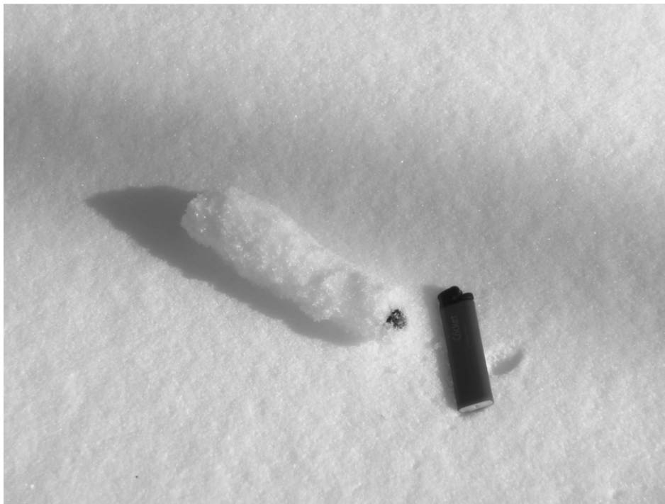
Рис. 2. Фотография, иллюстрирующая извлечение фирнового столбика с метеоритом (на фото рядом с образцом находится зажигалка для масштаба).
